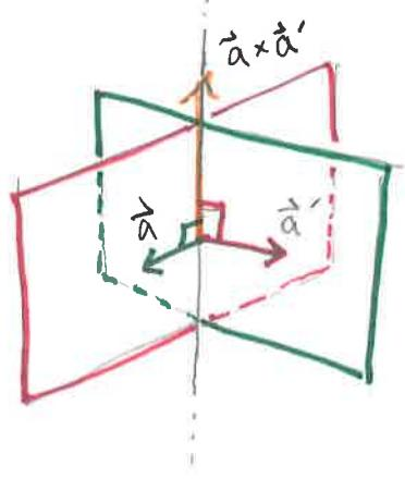
$$\vec{a} = \begin{bmatrix} a \\ b \\ c \end{bmatrix} \perp \text{to } 1^{\text{st}} \text{ plane}$$
